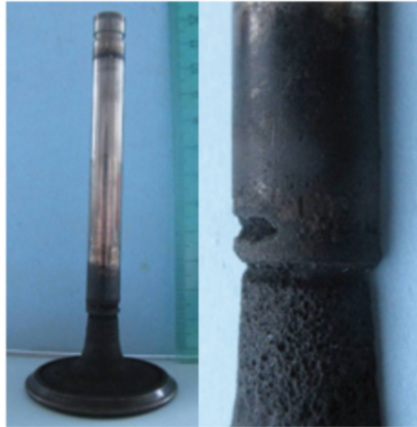
Abb 1: (a) Schadbauteil im ausgebauten Zustand, (b) Kritischer Oberflächenzustand im Übergangsbereich zum Schaft (rechts)
